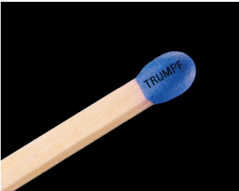
▲ Beispiel für »kalte Bearbeitung« mit Ultrakurzpulslasern. Die Pulse sind so kurz, dass sich das Bauteil – auf dem Bild ein Streichholzkopf – bei der Bearbeitung nicht erwärmt.
