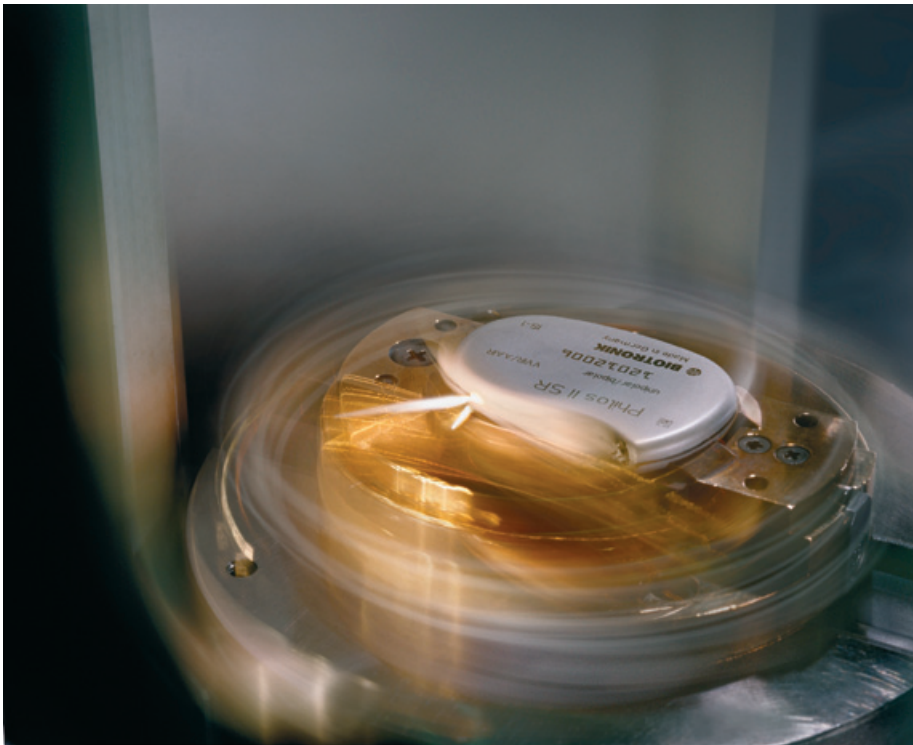
▲ Nahtschweißung an einem Herzschrittmacher. Die empfindliche Elektronik im Inneren wird beim Laserschweißen nicht beschädigt.
