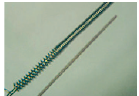
▲ Abb. 3: Geschweißte Mikropulpen aus Titan mit 0.3mm Durchmesser - zum Vergleich ein menschliches Haar
