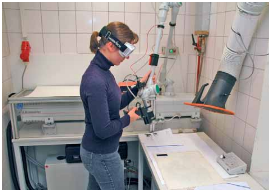
▲ Abb. 1: Q-Switch Nd:YAG-Laser (SAGA220/10) mit Gelenkarm zur manuellen Strahlführung im Laserzentrum der FH Münster
