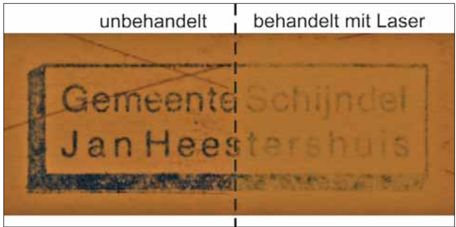
▲ Abb. 4: Mittels Laserstrahlung ( \lambda = 532 \text{ nm} ) reduzierte Stempeltinte auf Papier
