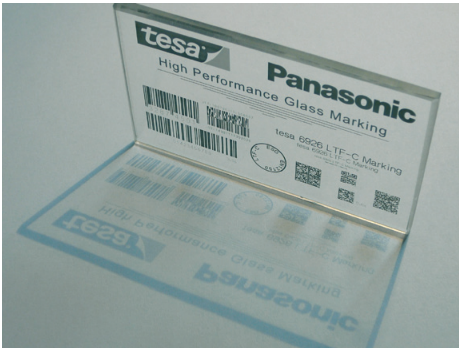
▲ Die LTF-C-Technologie liefert eine permanente, fälschungssichere Markierung mit hohem Kontrastspektrum auf Flachglas
