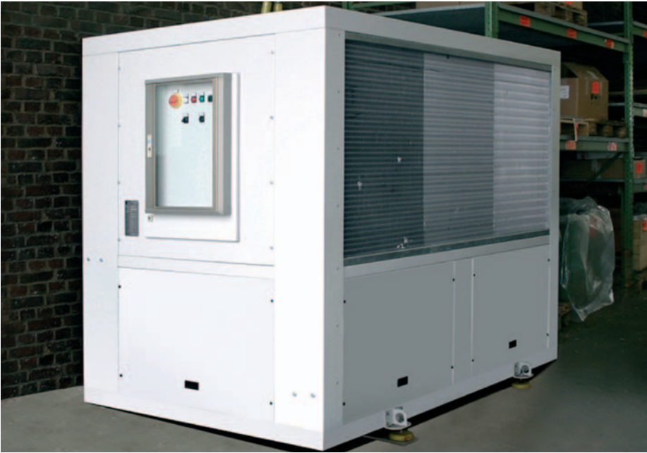
▲ Zur Kühlung von Resonator und Optik kommt bei Cloos Schweißtechnik eine Rückkühlanlage mit einer Kühlleistung von 66 kW zum Einsatz.
