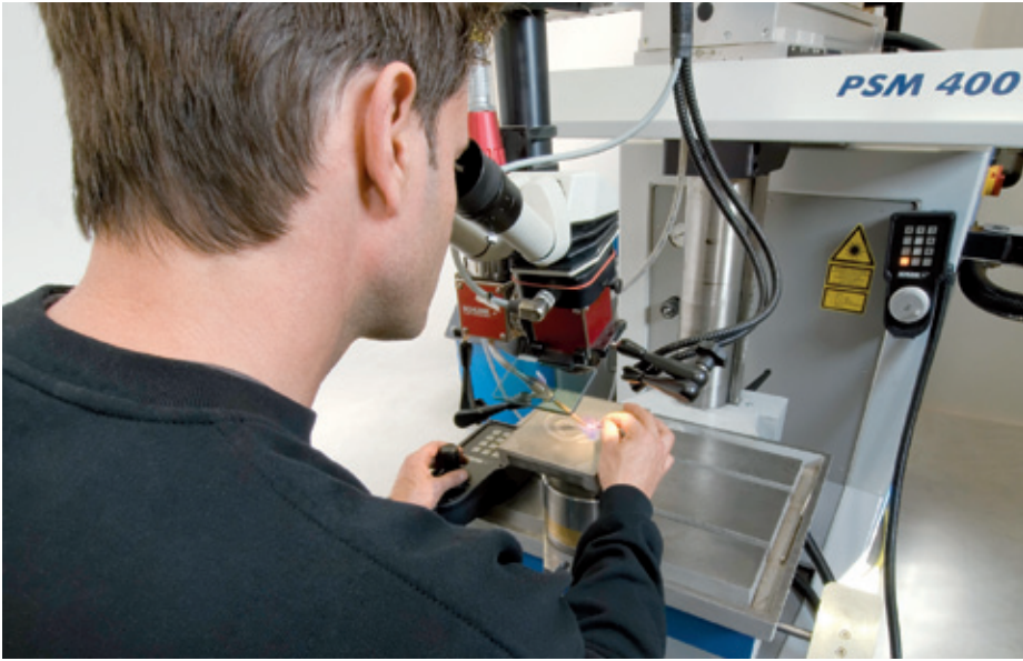
▲ Die Laserbearbeitungsmaschine PSM 400 von Schunk ist mit einem gepulsten Nd:YAG Laser ausgestattet. Bild: Schunk
