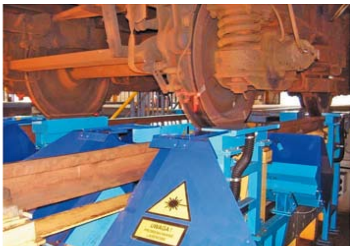
▲ Die roten Laserstrahlen scannen die Oberfläche des Radreifens und des Spurkranzes
