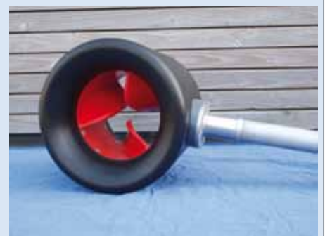
▲ Kompakt-Elektromotor des Unterwasserscooters.
