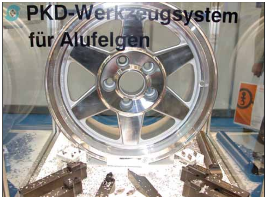
▲ PKD dreborid-Werkzeugsystem für Aluminiumfelgen (80er Jahre).
