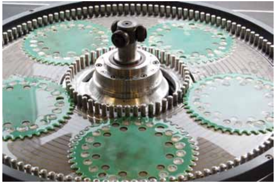
▲ Poliereinrichtung zum doppelseitigen Polieren von Kristallscheibchen für Laseranwendungen.
