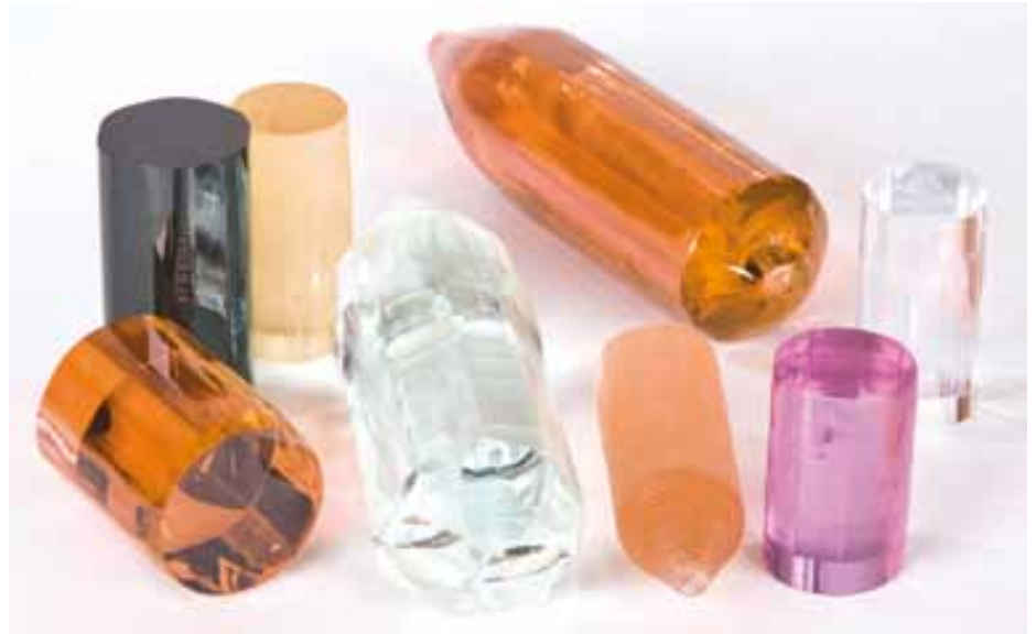
▲ »Bunte« Kristalle des FEE. Die Kristalle haben Durchmesser zwischen 50 und 80 mm bei Längen zwischen 140 und 300 mm. Es handelt sich um folgende Kristalle (von links nach rechts): Er:YAG, Cr:YAG, TGG, Yb:YAG, TGG, Nd:YAG, YAG und Er:YAG (hinten)
