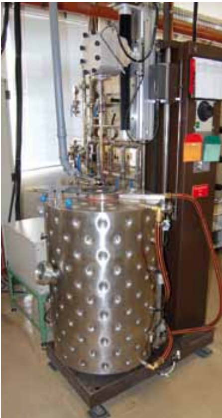
▲ Anlage zur Züchtung von Kristallen nach dem Czochralski-Verfahren.
