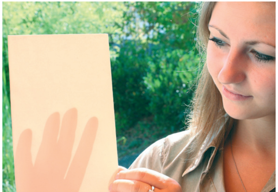
▲ Papiertechnologische Keramiken eröffnen neue Perspektiven für den Leichtbau. Sie eignen sich für Hochtemperatur-Anwendungen bis 1.600 °C.
