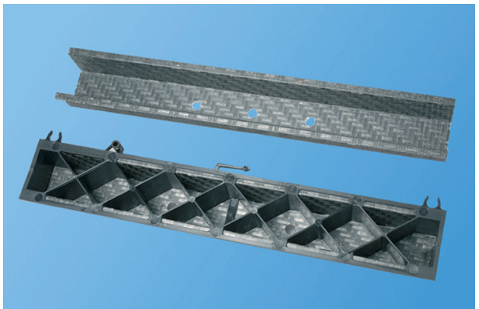
▲ Beim »Erlanger Träger« – einem für Standarduntersuchungen verwendeten Modellträger – liegen die mechanischen Kennwerte der Organoblech-Hybridkonstruktion signifikant höher als bei einem Pendant auf der Basis von Blech. Dadurch können solche Bauteile deutlich mehr Energie aufnehmen.
