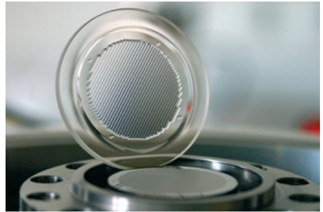
▲ Das fertig geprägte Linsenarray steht schräg hinter dem unteren Formeinsatz des Prägewerkzeugs © Fraunhofer IWU
