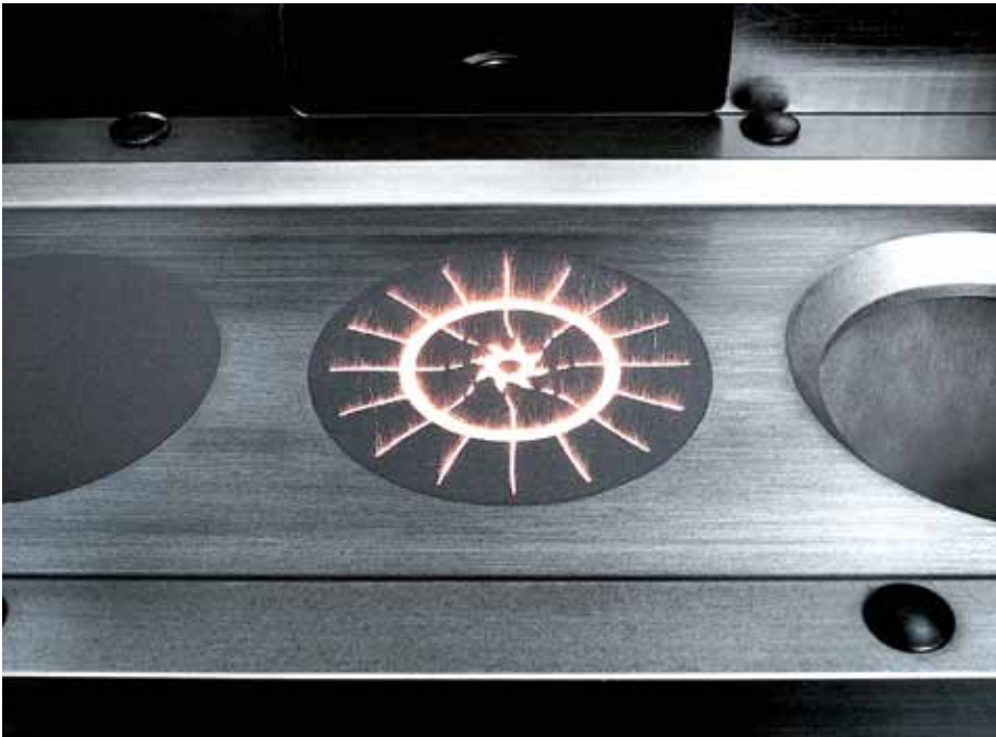
▲ Der Laser baut das Werkstück Schicht um Schicht aus einem Pulverbett heraus auf.
