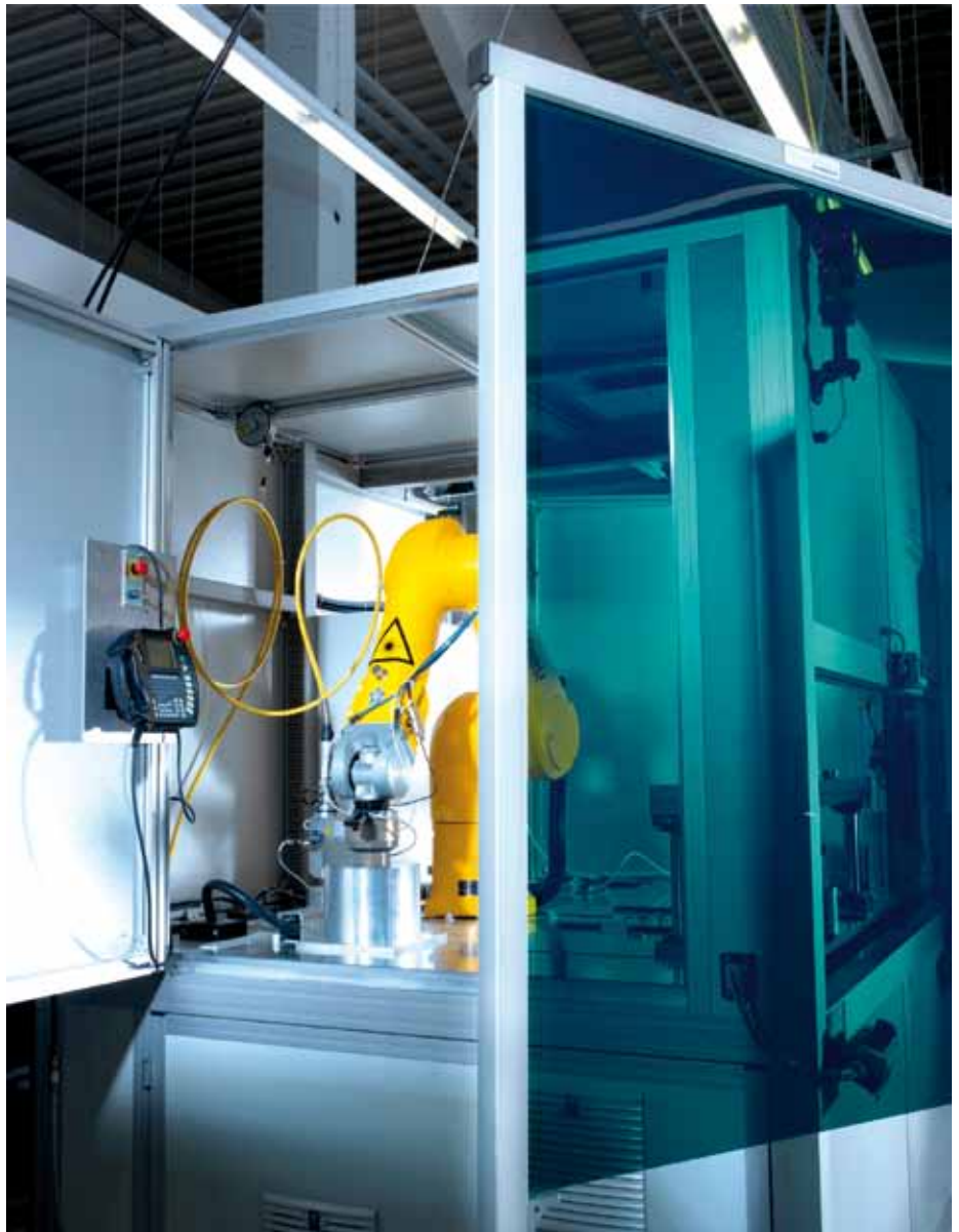
▲ Die neue blaue Scheibe sichert hohe Schutzstufen (Anlage: LPKF).
