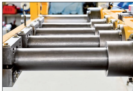
▲ Zentrale Komponenten des Crashmoduls: Crashabsorber aus hochmanganhaltigem Stahl. Bild: DLR
