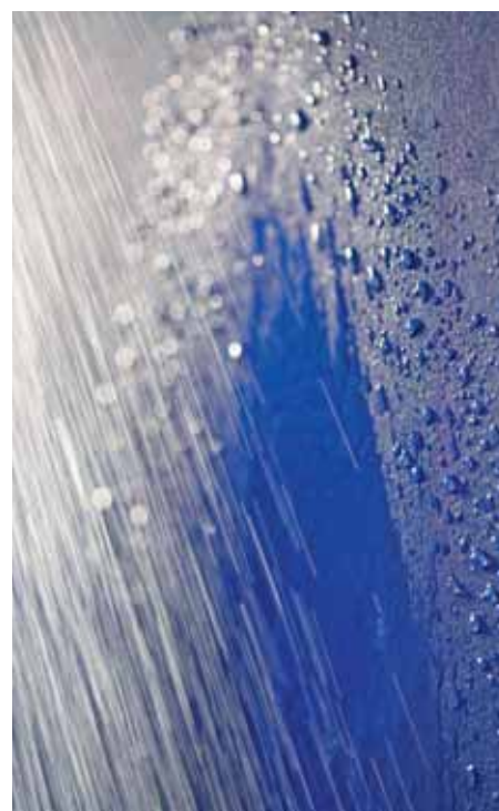
▲ Dauerberegnungstests, die den Einsatz an Duschen und Badewannen nachstellen, haben bewiesen: Selbst nach einer Woche durchgehender Befeuchtung ist kein Wasser eingedrungen.
