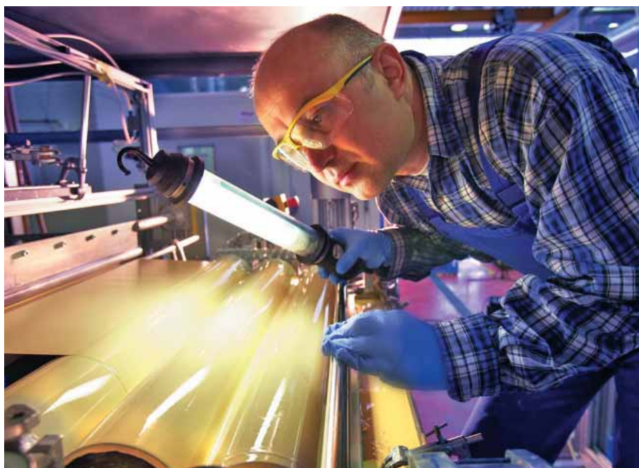
▲ Überprüfung der Qualität des keramischen Wandbelages mit einer Stablampe
