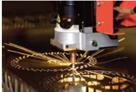
▲ Laserschneiden mit einem UV-Laser. Bild: Bystronic Deutschland GmbH
