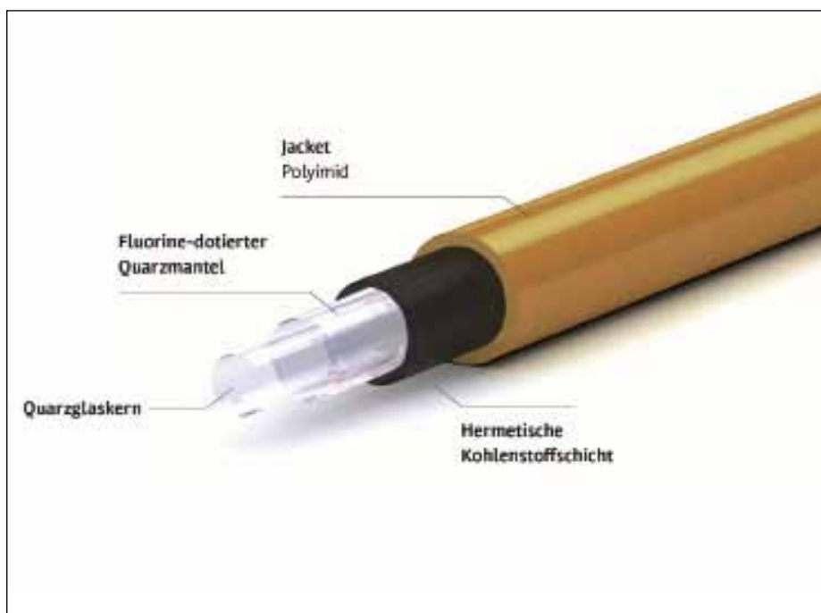
▲ CeramOptec UV NSS Faser mit Quarzglas kern, fluorine-dotiertem Quarzmantel, hermetischer Kohlenstoffschicht und Polyimidjacket. Bild: CeramOptec
