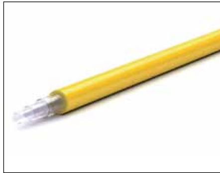
▲ Optran MIR Faser von CeramOptec mit Silberhalogenid-Kern und -Cladding sowie PEEK-Schutzschlauch. Copyright: Riba:BusinessTalk GmbH
