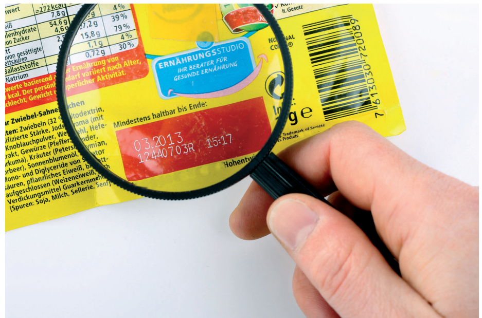
▲ Die Druckfarbe auf der Suppentüte wird durch den CO 2 -Laser abgetragen. Quelle: Fotolia
