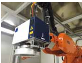
▲ Laserzelle mit neuer Laserschweißoptik iPFO von Trumpf und neuem Bergmann & Steffen Gebläse-Crossjet »Tornadoblade«. Foto: Bergmann & Steffen
