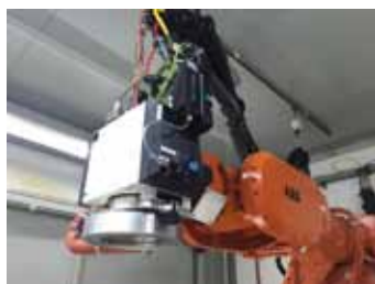
▲ Laserzelle mit Laserschweißoptik Intelliweld 30FC-V von Scanlab, Online-Nahtführungssystem »Weldeye« und Bergmann & Steffen Gebläse-Crossjet »Tornadoblade«. Foto: Bergmann & Steffen
