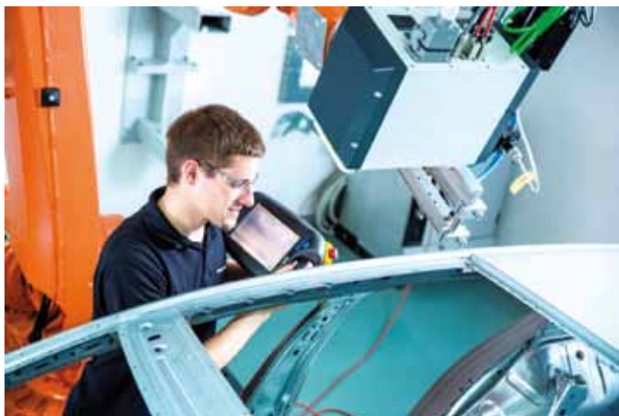
▲ Laserzelle mit Scanlab/Blackbird Scanner im Teach-Modus. Foto: Bergmann & Steffen
