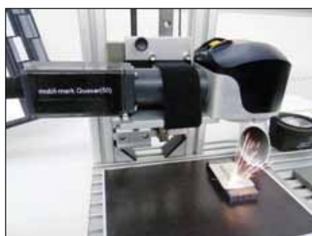
▲ mobil-mark Quasar optimiert Laserbeschriftung in automatisierten Produktions- und Montageprozessen.
