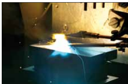
▲ Dickblechschweißen mit 60 kW Laserleistung mit Diodenlaser-Technologie von Laserline.
